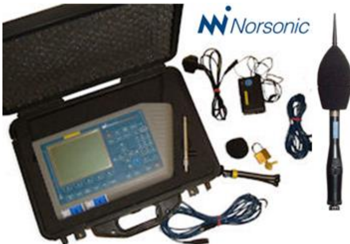
100 pav. Triukšmo lygio matavimams naudojamas skaitmeninis garso analizatorius Nor121
